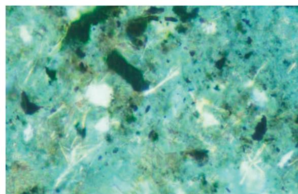
*Sl. 3.3.5:* Isto kot na *sl. 3.3.4*. Pod navzkrižnimi polarizatorji so lepo vidna večja kremenova zrna (belo). Sivo so drobna večinoma kremenova zrna, med katerimi so večja in manjša neprozorna zrna in podolgovati preseki iglic rutila in lističev sericita, ki imajo visoke interferenčne barve (rumenkasto). Presevna polarizirana svetloba, + N, dolžina dolgega roba slike 0,14 mm.
