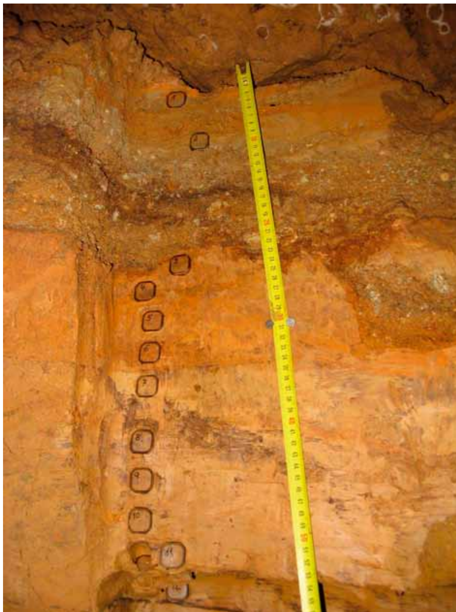
Sl. 2: Vzorcevanje sedimentnega profila v Tajni jami za paleomagnetne analize z nemagnetnimi plastičnimi škatlicami.
